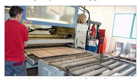
"Hotcoating"-Beschichtung mit drei Walzen (Heißwalze, Auftragswalze und revers laufende Glattwalze)
