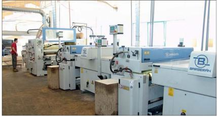
Barberán-Beschichtungsanlage für "Hotcoating"-Oberflächen bei Lico. Hinten links ist noch ein Teil der Durst-Digitaldrucklanlage "Rho 750" erkennbar. Die bedruckten Platten können gleich anschließend durch die "Hotcoating"-Anlage laufen. Rechts neben dem Mitarbeiter ist die Walzenauftragseinheit zu sehen. Dahinter folgen die Anlagen für den Auftrag von UV aushärtendem Acryl-Hochglanzlack. Die ganze Anlage ist weniger als 7 m lang.
