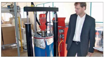
Jens Fandrey neben der Fassschmelzanlage des Schweizer Herstellers Balti AG. Über eine speziell gehärtete Schneckenpumpe (wegen des hohen Korundanteils) wird das nun flüssige PUR-System zur Barberán-Anlage gefördert.
